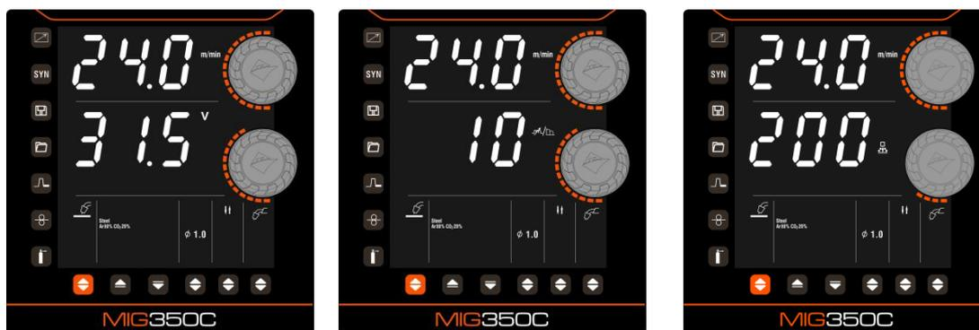
(Velocità di avanzamento del filo e impostazione della tensione) (Impostazione dell'induttanza)
