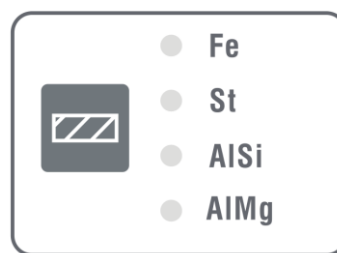
Figura 1-2 Zona di selezione dei metalli di base
