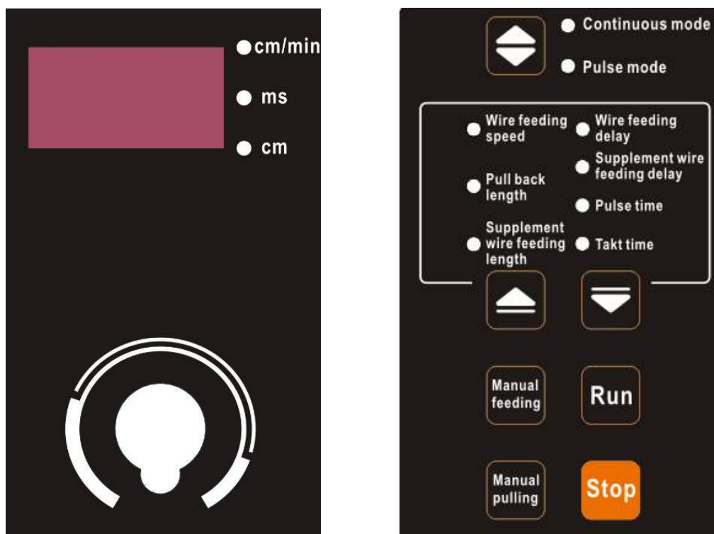
Figura 3-9 Schema del pannello del trainafile
