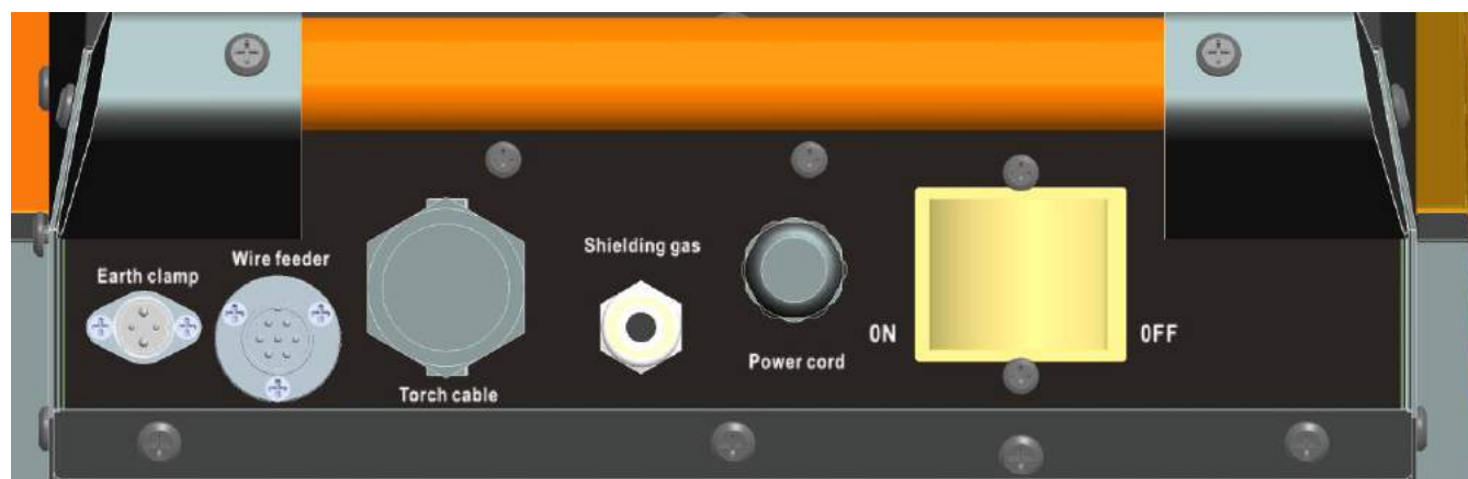
Figura 3 -8 Diagramma schematico del pannello posteriore
