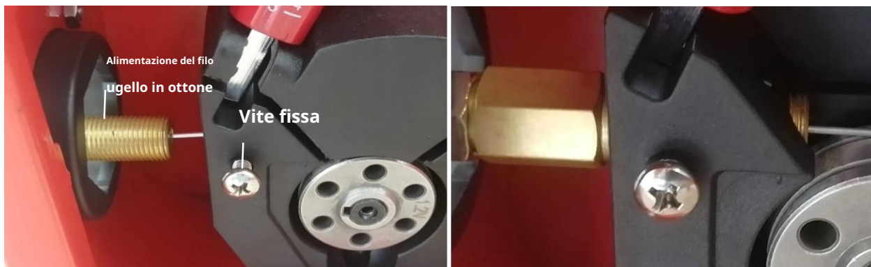
Figura 4-4 Assemblaggio dell'ugello in ottone per l'alimentazione del filo
